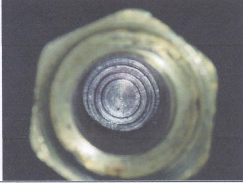
图 29 测试后 5# 无进水
