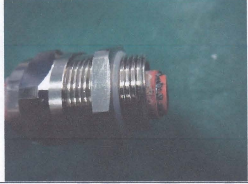
图 30 测试后 6# 无进水
